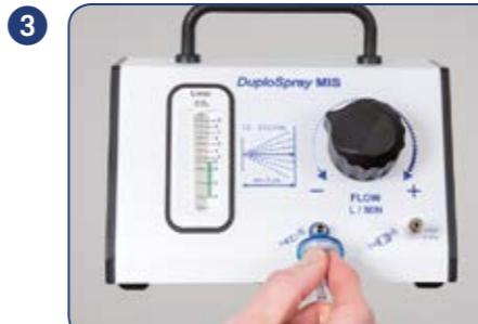
Připojte sprejovací sadu k regulátoru. Připojte modře označený filtr odvzdušňovacího vedení k modrému konektoru typu luer s vnitřním závitem a neoznačený filtr vedení plynu ke konektoru typu luer s vnějším závitem na regulátoru.
