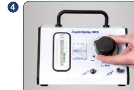
Při stisknutém nožním pedálu upravte rychlosť průtoku plynu na 1,0–2,0 litry za minutu. Při stlačení nožního pedálu zkонтrolujte průtok plynu ověřením výšky kuličky v rotametru.
