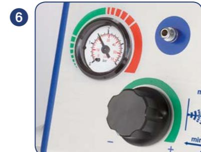
Zkontrolujte tlakoměr na zařízení EASYSpray, zda ukazuje správný rozsah tlaku 1,5–2,0 bara (21,5–28,5 psi). Upravte nastavení tlaku otočením černého ovladače pro regulaci tlaku.
