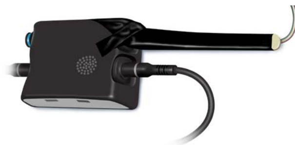
Obrázek 5: Spojení řídicí jednotky a přípojky páskou
