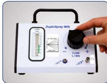
Při stisknutí nožního pedálu upravte rychlost průtoku plynu na 1,0–2,0 litry za minutu. Při stlačení nožního pedálu zkontrolujte průtok plynu ověřením výšky kuličky v rotametru.
