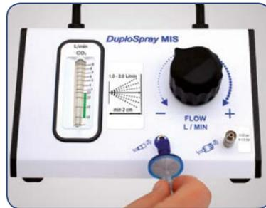
Připojte sprejovací sadu k regulátoru. Připojte modře označený filtr odvětrávacího vedení k modrému konektoru typu luer s vnitřním závitem a neoznačený filtr vedení plynu ke konektoru typu luer s vnějším závitem na regulátoru.
